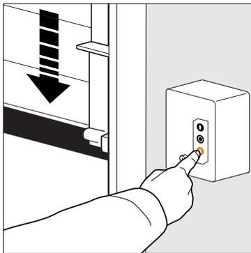
Durch kurzes Betätigen des Tasters 'Zu' (↓) schließt das Tor bis in die untere Endlage.
