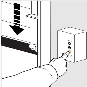
Durch kurzes Betätigen des Tasters 'Zu' (↓) schließt das Tor. Die Abwärtsbewegung stoppt bei Freigabe des Tasters 'Zu'.
