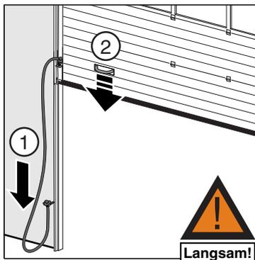
Torblatt mittels Zugseil aus der Ablageposition herunterziehen (1), dann am Handgriff den Schließvorgang fortsetzen (2).
