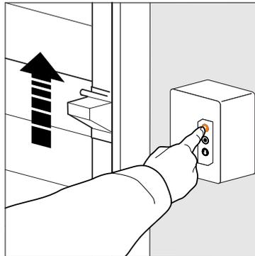
Durch kurzes Betätigen des Tasters 'Auf' (↑) öffnet das Tor bis in die obere Endlage.
