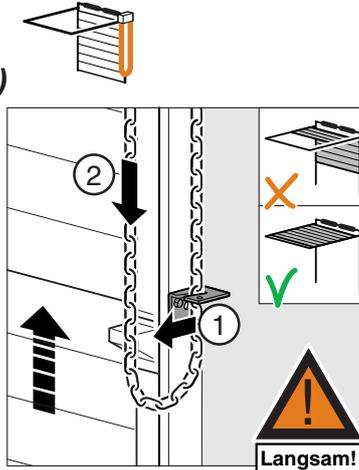
Betätigungskette aus dem Wandhalter nehmen (1). Durch ruhiges, gleichmäßiges Ziehen der Kette das Tor öffnen (2). Kette sichern.
