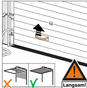
Torblatt am Handgriff hochziehen und bis an den Anschlag (Federpuffer) führen.
